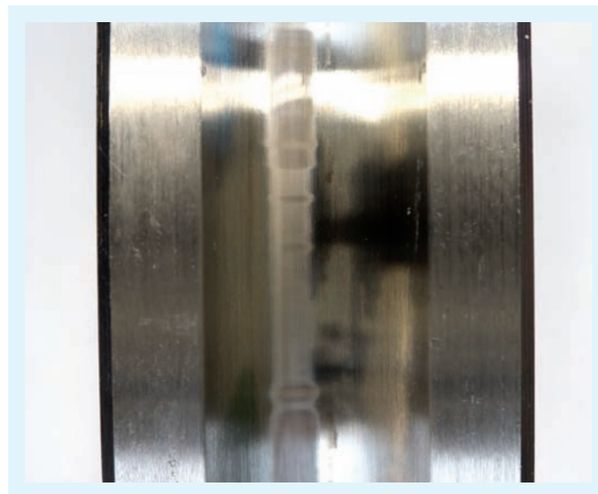
Abb: Innenring mit Laufbahnschaden infolge Stromfluss
